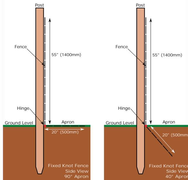
Tanto la altura de la valla como la longitud del delantal pueden configurarse para adaptarse a las necesidades individuales. La guía del delantal puede colocarse en el suelo o enterrarse en varios ángulos, según la aplicación.
